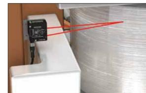
**16 Medição do Diâmetro de Bobinas**
